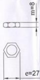
Part No.7 NUT M16 DIN 439
